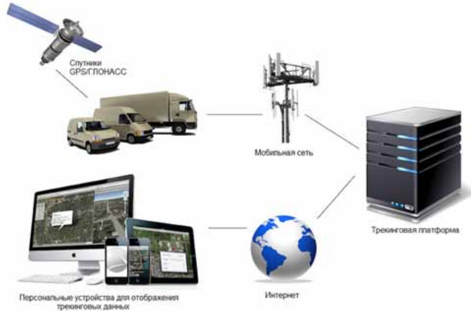
Рис. 4. Пример трекинговой системы
